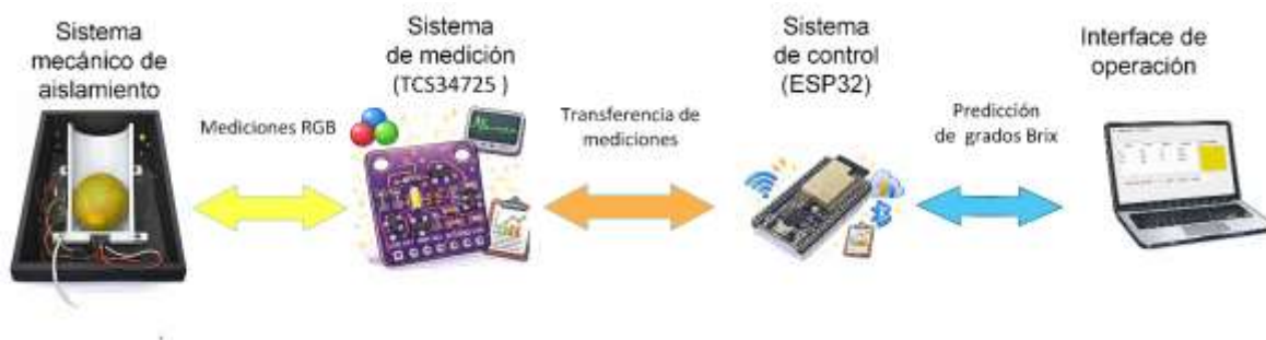
Figura 1. Diagrama de general del sistema colorímetro inteligente para la de estimación grados Brix mediante mediciones RGB.
