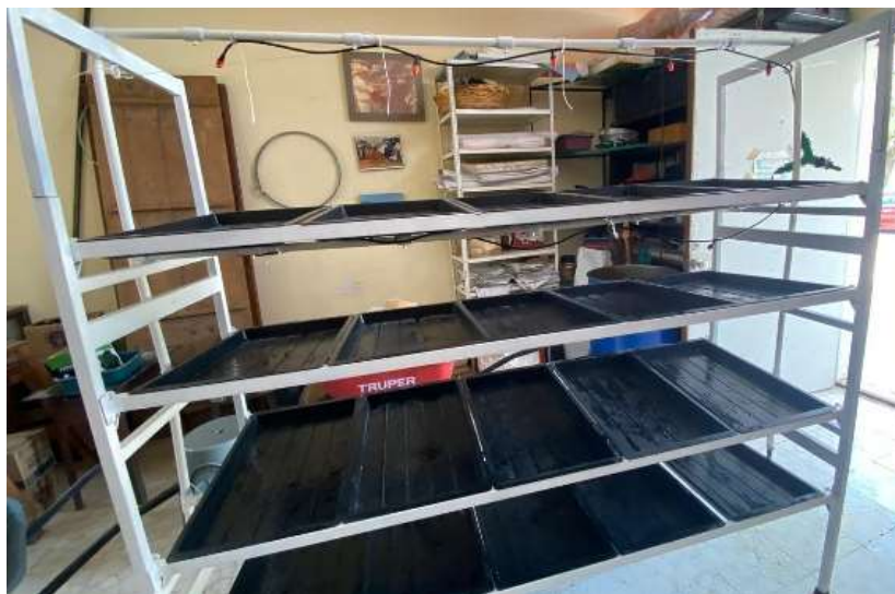
Figura 4. Estructura final del estante con los componentes básicos para la producción de forraje verde hidropónico (sistema con aspersores, tubos de PVC y charolas de germinación).
