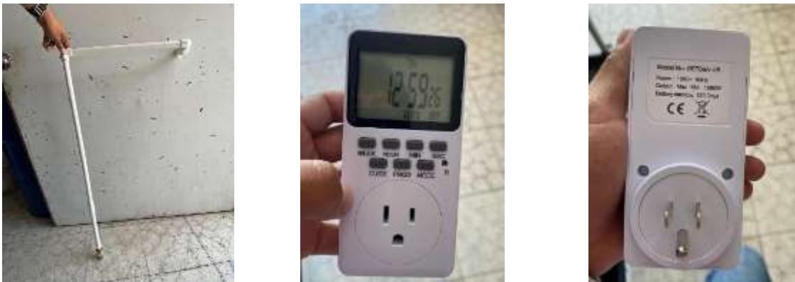
Figura 3. Sistema de conexión y timer: a) Tubo de entrada de pichanca hacia el bote de 200 litros, b) Timer por la parte frontal, c) Timer por la parte posterior.
