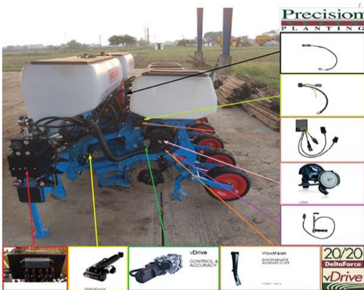
Figura 2. Sembradora bajo el sistema precisión planting y sus componentes
