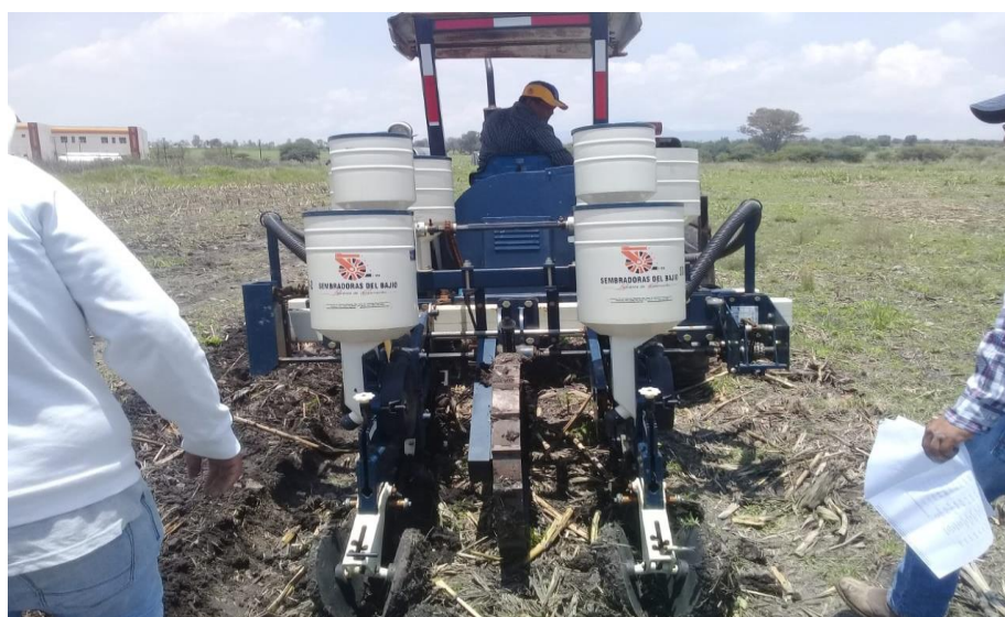
Figura 1. Sembradora de precisión (Bajío) neumática modelo SD-2011-DSCF-2
